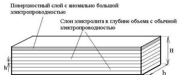
Рис. 5. К расчету удельной электропроводности поверхностных слоев электролита / Fig. 5. To the calculation of the specific electrical conductivity of the surface layers of the electrolyte
