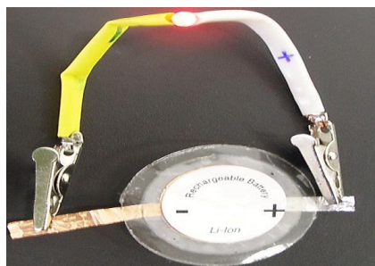
Рис. 5. Опытная модель тонкой батарейки с новым катодом на основе литий-марганцевой шпинели / Fig. 5. Experimental model of a thin battery with a new cathode based on lithium manganese spinel
