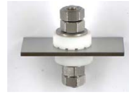
Рис. 6. Вид образца для испытаний на стойкость против щелевой коррозии
