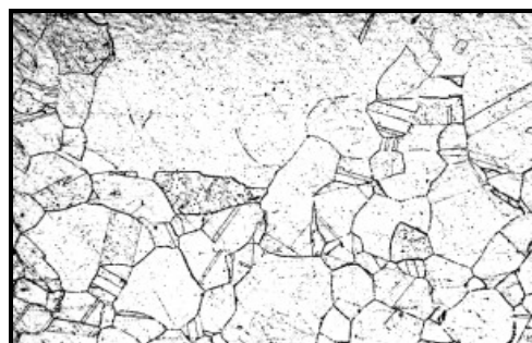
Рис. 7. Микроструктура образца холоднокатаной трубы \varnothing 20 \times 2 мм из стали 02X18H11 после двойной закалки от 1 170 °С (вторая из которых проведена после правки), \times 100 / Fig. 7. Microstructure of a specimen taken from cold-rolled \varnothing 20 \times 2 mm tube made of 02Cr18Ni11 steel after double quenching from 1 170 °С (the second quenching was carried out after straightening), \times 100
