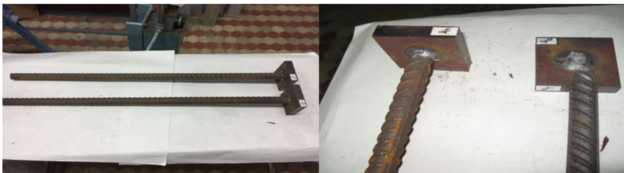
Рис. 4. Загальний вигляд з'єднання арматурних стрижнів Ø32 мм із пластиною двостороннім зварюванням: 4 1 –4 2 – маркування зразків та його характер руйнування
