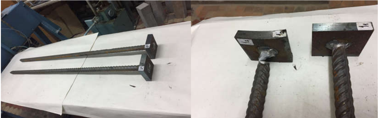
Рис. 1. Загальний вигляд з'єднання арматурних стрижнів Ø25 мм із пластиною двостороннім зварюванням: 1 1 –1 2 – маркування зразків та його характер руйнування
