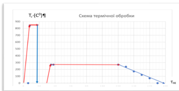
Рис. 2. Схема термічної обробки клинка із композитної сталі ШХ15Ш в обкладках 40Х13
