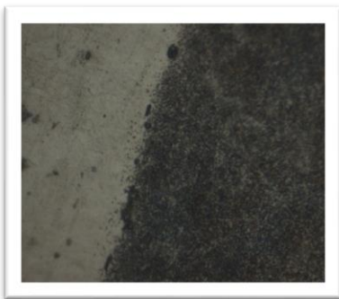
Рис. 6. Мікроструктури композиту із сталі ШХ15Ш в обкладках 40X13 зварювальний шов, ×500
