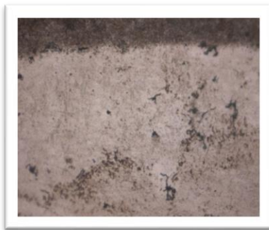
Рис. 7. Мікроструктури композиту із сталі ШХ15Ш в обкладках 40X13 зварювальний шов, ×1000
